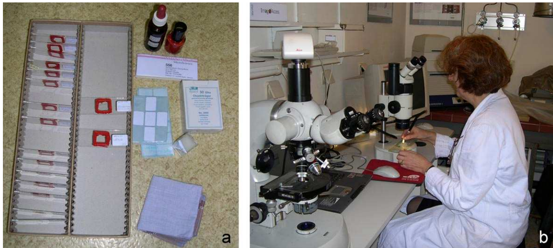
Abb. 2: Probennahmen für Auflicht- und Durchlichtmikroskopie, Institut für Archäometrie der Universität für angewandte Kunst Wien (Fotos: K. Grömer).
